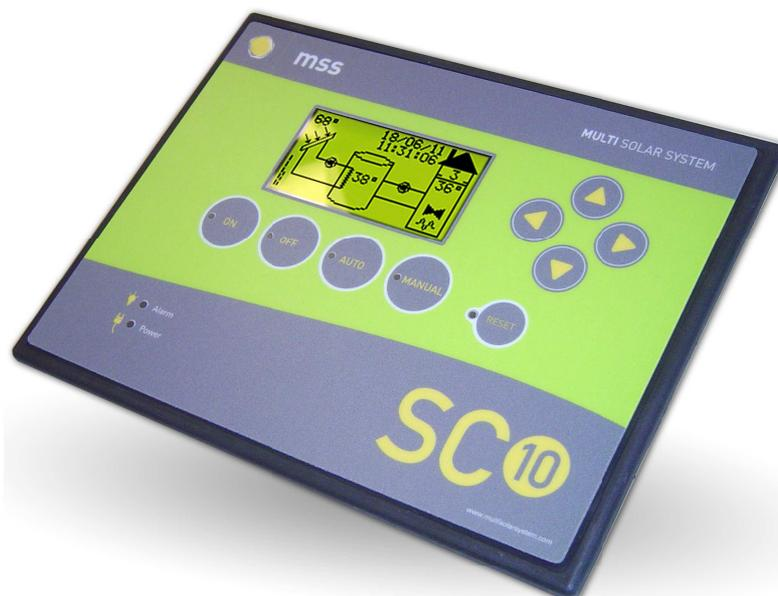
La central SC10 está diseñada para controlar la producción de ACS en edificios de viviendas. Sus características y funcionamiento están pensados para controlar el funcionamiento de las bombas y dispositivos del sistema al mismo tiempo que calcula la energía solar producida por la instalación.
